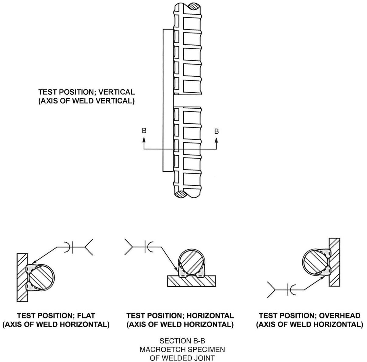
FLARE-BEVEL-GROOVE INDIRECT BUTT-JOINT
