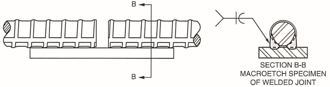
**FLARE-BEVEL-GROOVE INDIRECT BUTT-JOINT**
